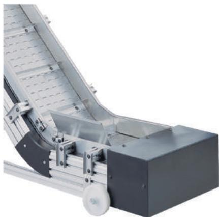
Transportador inclinado robusto, ideal para trabajo pesado y operación continua en múltiples turnos. Cuenta con una banda articulada de acero, adecuada para piezas calientes o filosas, como partes estampadas, fundidas o de madera. Puede configurarse como inclinación recta o en forma de cuello de ganso (Z), con secciones horizontales en entrada y/o salida.
