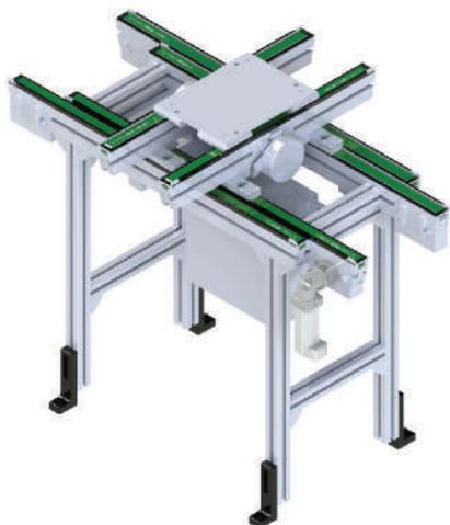
Permite construir soluciones para transportar productos de diferentes dimensiones en la misma línea de producción. El objetivo de este conveyor es ajustar el ancho del transportador en lugar de usar rieles o guías que vulneren la rigidez de la máquina. Ajustando la distancia entre las bandas se reducen posibles atascos con los Pallets y se consigue un sistema flexible y optimizado para el transporte de productos.
