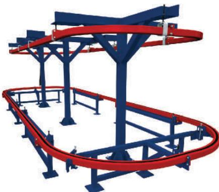
Ideal para cargas ligeras, zonas de buffer o ergonomía en estaciones de trabajo. No requiere motorización eléctrica y permite acumular manualmente.
