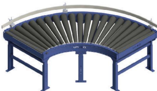
Su diseño compacto permite una fácil integración en espacios reducidos, asegurando una alimentación continua y ordenada de paquetes. El movimiento se transmite mediante rodillos con surcos y bandas redondas, y puede controlarse por zonas motrices a 24 VDC o mediante un motorreductor de corriente alterna para aplicaciones de flujo continuo.
