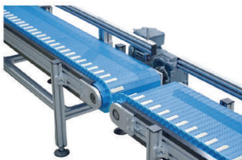
Transportador de banda modular plástica, ideal para cargas pesadas incluso con anchos reducidos. Su diseño permite reemplazar secciones dañadas sin cambiar toda la banda, ahorrando tiempo y costos. La tracción positiva mejora la estabilidad, y su resistencia al desgaste lo hace ideal para la industria alimentaria, automotriz o aplicaciones con altas temperaturas o químicos agresivos.
