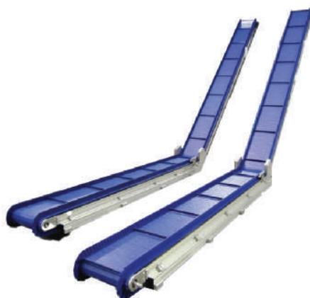
Transportador inclinado de banda modular plástica con secciones horizontales en la entrada, salida o ambas. Ideal para piezas moldeadas, alimentos o productos que requieren cambios de altura. Su banda modular ofrece alta resistencia al desgaste y puede fabricarse en materiales aptos para alimentos, altas temperaturas o ambientes químicos, lo que lo hace versátil y duradero.
