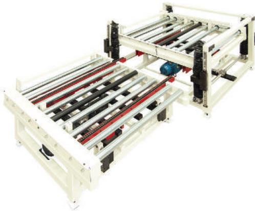
Fabricamos equipos personalizados para transferir a 90° productos voluminosos, como tarimas de madera o plástico, de manera eficiente. Son soluciones robustas y configurables que se adaptan a distintas necesidades de almacén sin limitaciones por otros elementos instalados.
