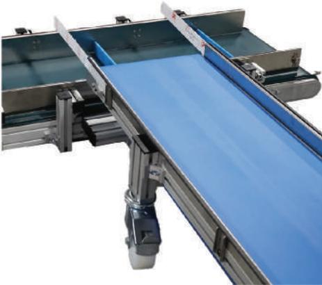
Transportador de banda construido con perfil de aluminio de altura compacta, solo 35 mm, perfecto para el manejo de piezas pequeñas o la eliminación de recortes. Este transportador de banda plana está disponible en tres anchos estándar y ofrece una variedad de opciones de accionamiento y diámetros de poleas para un excelente desempeño a alta velocidad.
