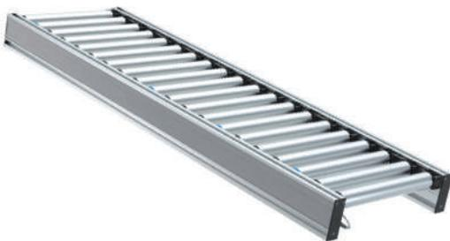
Este transportador liviano está construido con perfiles de aluminio estructural, lo que facilita su integración en sistemas de elevación, módulos rotativos o incluso su instalación suspendida a gran altura. Con una capacidad de carga de hasta 200 kg, puede equiparse con controladores EtherNET/IP para conectividad en red, cumpliendo así con los altos estándares de una línea de ensamble moderna.
