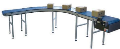
Transportador de banda plástica curva que ofrece doce opciones de ancho, desde 164 mm hasta 1,005 mm, y configuraciones de curvatura en ángulos de 45°, 90° y hasta 180°. Cuenta con tres diseños estándar que pueden adaptarse o modificarse según los requerimientos del sistema. Además, permite realizar pequeños cambios de elevación, lo que lo convierte en una solución flexible para líneas con trayectorias curvas y variaciones de nivel.
