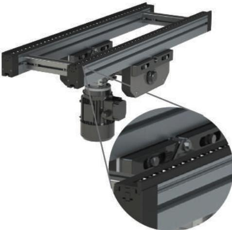
Diseñado para manejar cargas acumuladas de hasta 700 kg, con 2 kg por rodillo, este transportador es ideal para tarimas grandes y pesadas, resolviendo desafíos que las bandas dentadas tradicionales no pueden superar. Su configuración es flexible al milímetro en ancho y longitud, y sus rodillos de baja fricción aseguran un desplazamiento suave y continuo del producto.
