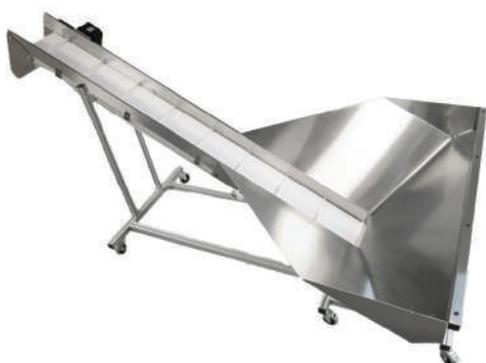
El transportador tipo Z-Frame, con perfil estructural de 50 x 50 mm, es un equipo modular que puede integrarse en sistemas nuevos o existentes o utilizarse de forma independiente para manejar y cargar materiales a granel. Sus bandas con cangilones ofrecen un soporte eficiente en inclinaciones pronunciadas.
