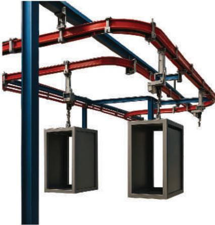
Sistema motorizado ideal para flujos continuos, instalación sencilla en talleres y líneas de proceso. Utiliza cadena motriz interna y permite cambios de dirección y/o cambios de altura. Es posible usar mas de una unidad motriz para trayectorias de hasta 300 metros de longitud.
