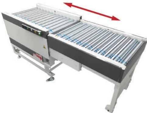
Este módulo es una puerta automatizada que se desliza en el riel del transportador, permitiendo el paso sin levantar la sección. Se abre y cierra con un botón, deteniendo y reiniciando el flujo automáticamente. Funciona con 24 VCC y es de fácil instalación.
