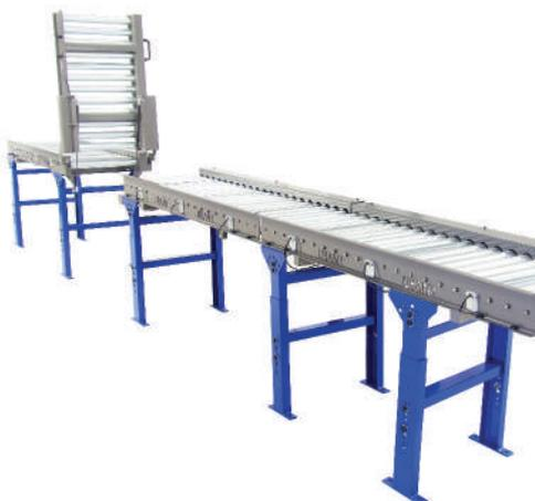
El módulo liftgate para transportadores de rodillos permite levantar o bajar una sección del sistema para facilitar el paso de personal en áreas de tránsito frecuente, evitando rodeos. Funciona como un puente abatible asistido por resortes de gas para un movimiento suave y seguro. Al bajar la compuerta, el transportador reanuda su operación normal, reduciendo interrupciones y mejorando la seguridad en el área de trabajo.
