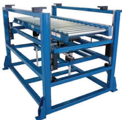
Los transportadores de rodillos con sistema de elevación son autónomos y compatibles con líneas existentes. Su diseño es completamente personalizable en distribución, número de rodillos y capacidad de carga. La altura de elevación se ajusta según las necesidades del proceso, y puede operarse mediante sistemas eléctricos o soluciones neumáticas de bajo costo.
