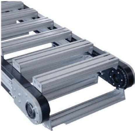
Es un transportador de cadena indexado con puntos de fijación, diseñado específicamente para operaciones cicladas o de indexación donde la posición definida es crítica. Este sistema utiliza una cadena con accesorios a la que se montan pallets o fixtures (como soportes en V), proporcionando un soporte confiable para las piezas de trabajo.
