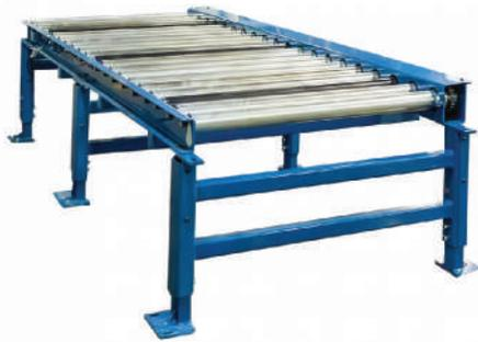
Transportador robusto para productos voluminosos sobre tarimas, con capacidad de hasta 1,300 kg. Su bastidor de acero de 3/16" cortado por láser asegura alineación precisa y contacto constante entre rodillos y carga. Disponible con comunicación EtherNET/IP o control analógico de velocidad y dirección.
